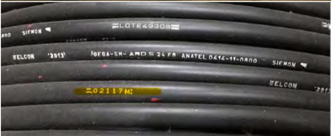
L02/01 Bobina cabo fibra ótica - 2.117 metros
