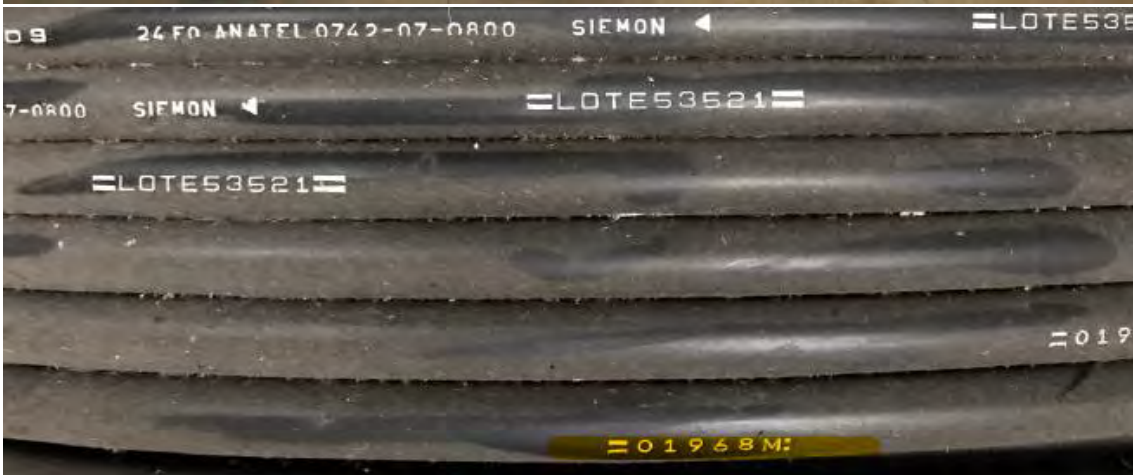
L02/02 Bobina cabo fibra ótica - 1.968 metros
